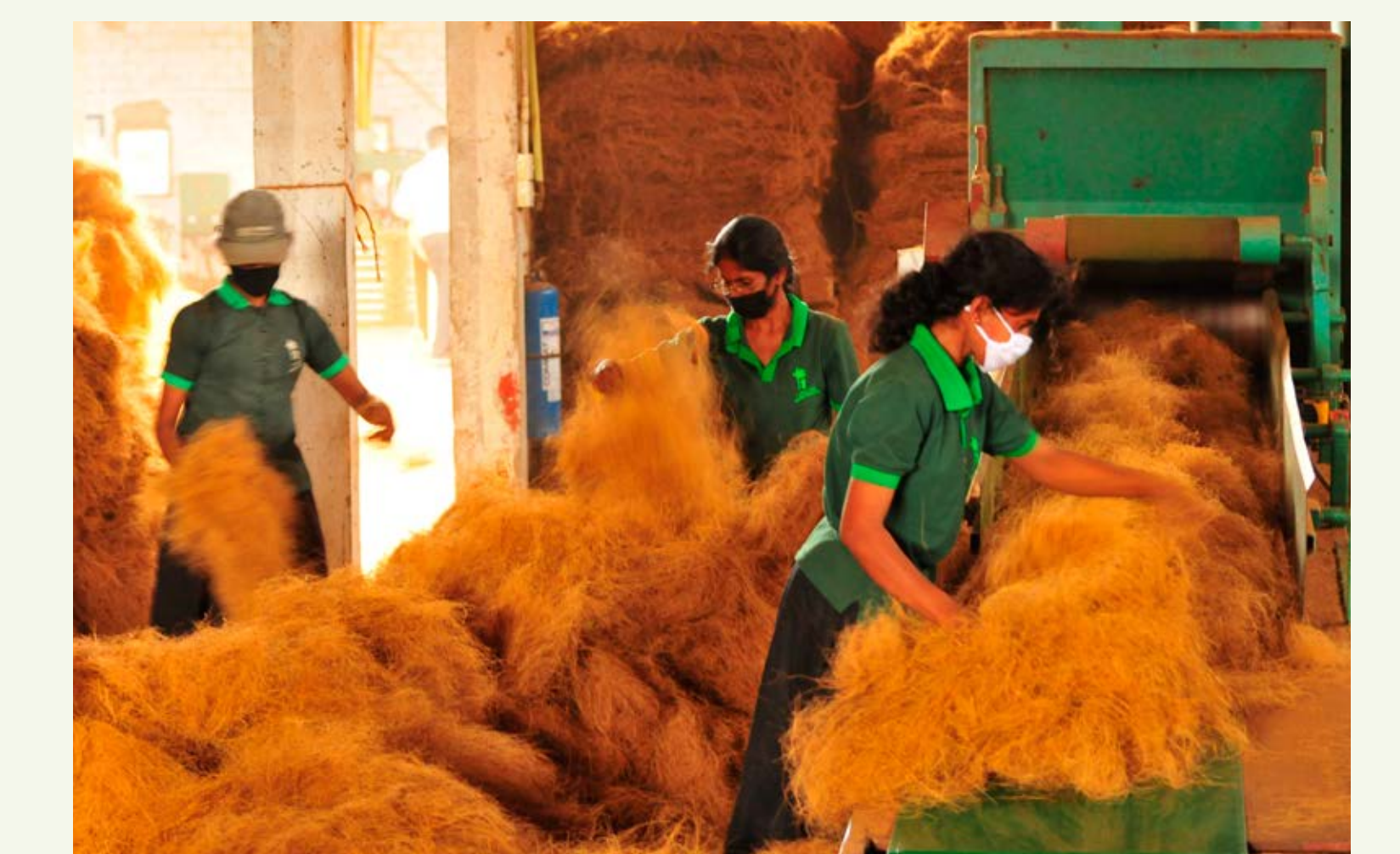
4. Kokosfasern werden ausgekämmt Coir fibers are being combed
