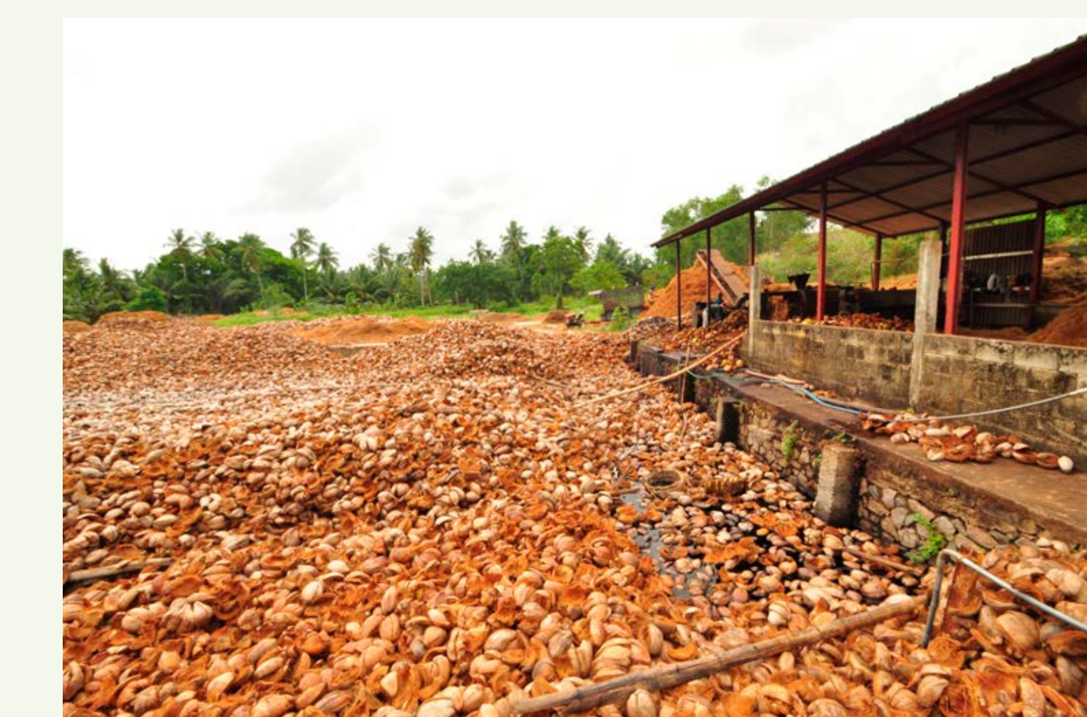
3. Einlegen der Kokosnuss-Schalen (Husk) Soaking of the coconut husk
